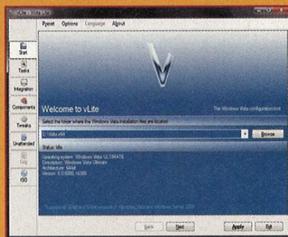
La première fenêtre de vLite vous demande où trouver les fichiers originaux de Vista et où enregistrer les fichiers de la nouvelle ISO.
